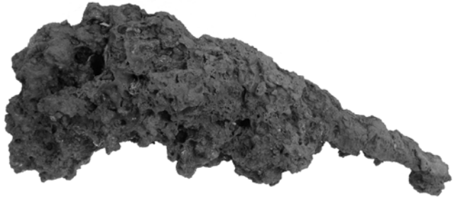
Schwammige kleine „Eisenluppe“ vom Rand einer Schlackenhalde. Dieser Fund ist selten, da auch geringe Mengen verarbeitet wurden.
